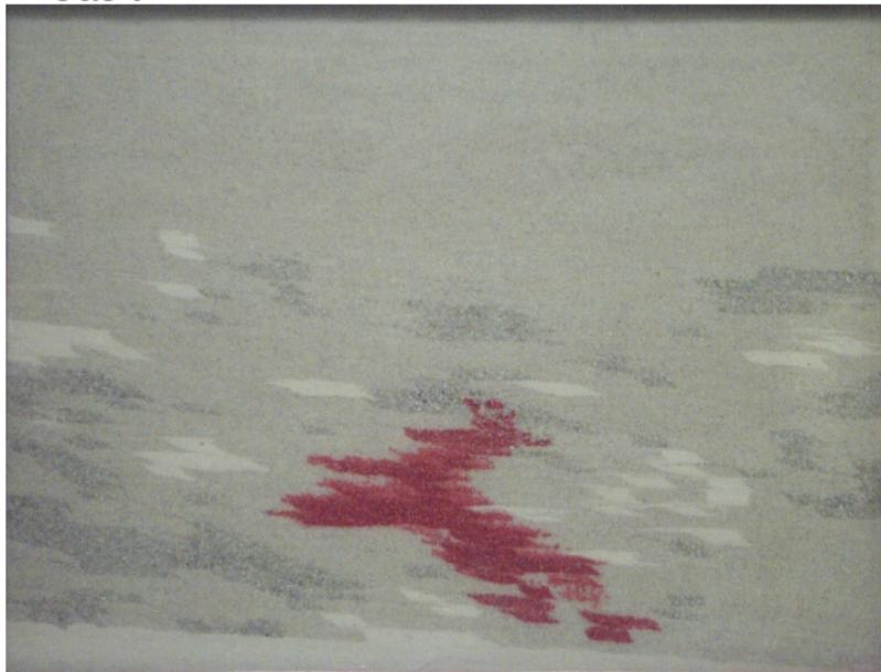
Snímek experimentu dvoufázového proudění v heterogenním porézním prostředí.
