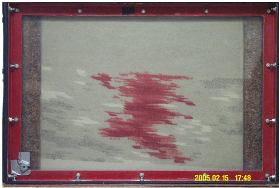
Snímek experimentu dvoufázového proudění v heterogenním porézním prostředí
